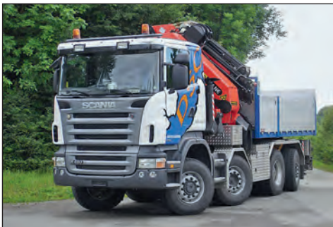
8x4*6: grue de 85 t/m. Treuil d'une capacité de 3,5 à 7 t.
