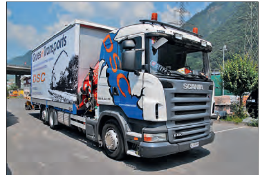
6x2*4: grue de 25 t/m, portée max. 17 m, horizontale 14 m, transpalette électrique.
