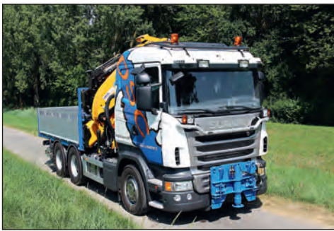
3 essieux Euro 6, grue d'une portée max. de 33 m, structure interchangeable.
