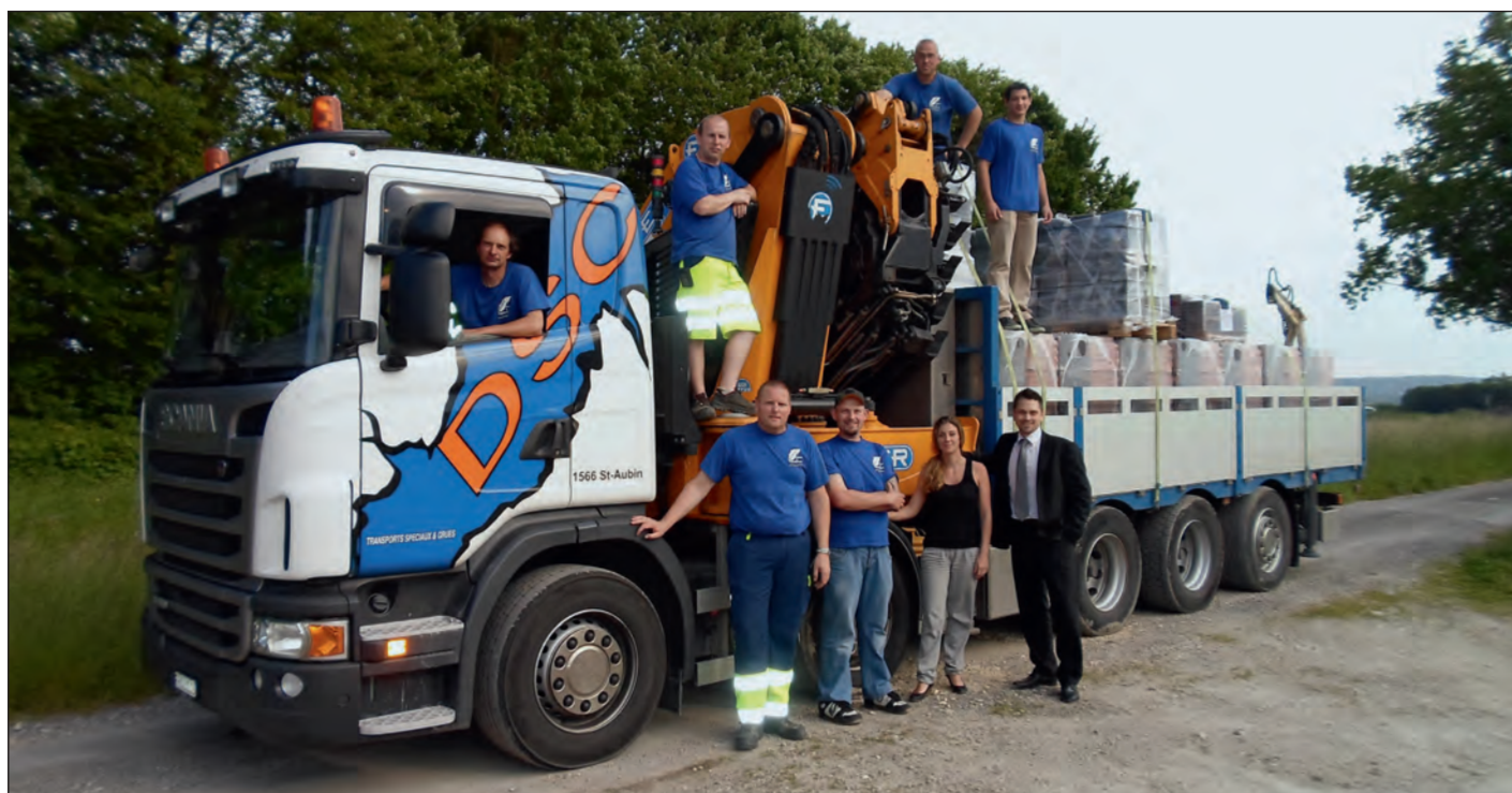
Les véhicules: ci-dessus, les collaborateurs de DSC Transports sàrl posent fièrement pour la photo sur un tracteur à cinq essieux (10x4*6) avec grue de 95 t/m, portée max. 42 m, horizontale 38 m, capacité de charge de 100 % sur 360° – même à vide. Hauteur du pont de chargement: 1,13 m.
