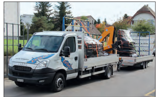
Camion – 3,5 t: grue de 6 t/m, portée max. 13 m, horizontale 10 m.
