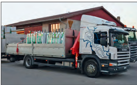
4x2: grue de 13 t/m, portée max. 12,5 m, horizontale 10 m.
