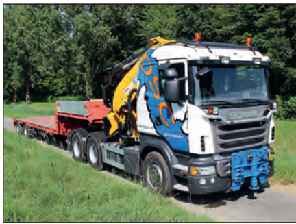
Semi-remorque extensible jusqu'à 17,4 m et directionnelle. Hauteur du plateau: 90 cm. Essieux directionnels et télécommandés.
